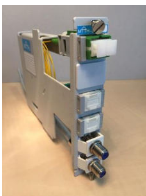
Zdjęcie 2. Widok modułu abonenckiego budynkowego (MAB).
